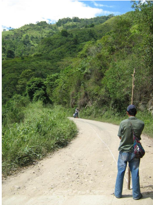
Figura 3. Levantamiento de poligonal en vía Arboledas – Cucutilla de la Formación Aguardiente.
