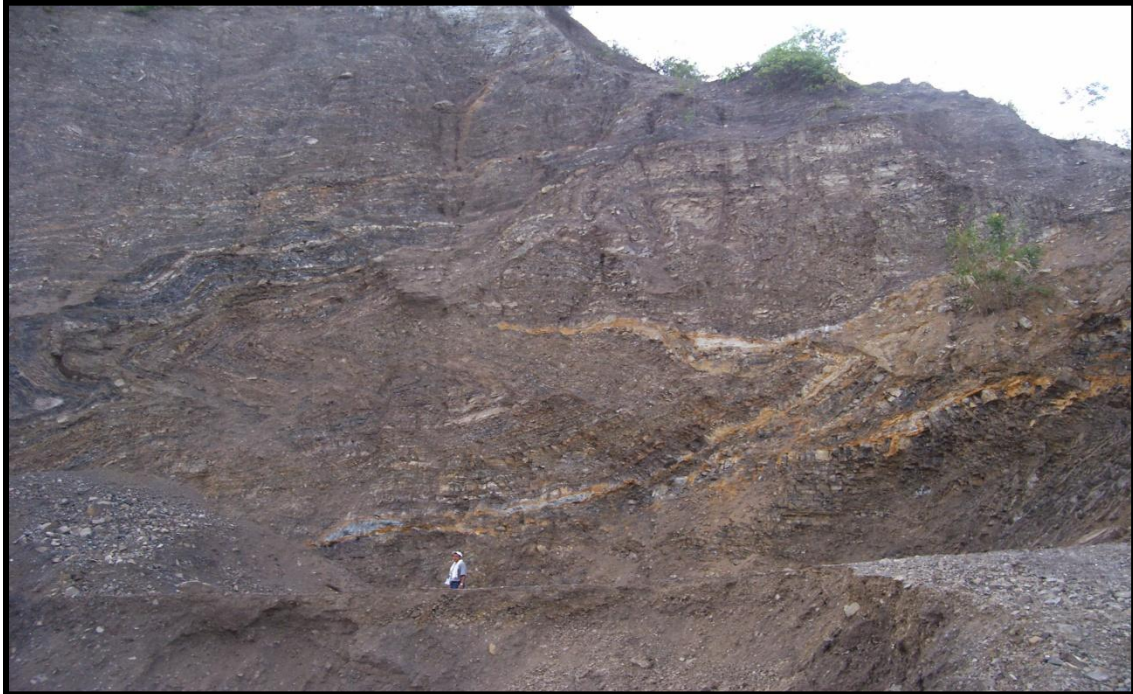
Figura 51. Cantera de explotación de las liditas de la Formación Luna que son utilizadas para el mantenimiento de las vías secundarias de la región (Vía Durania – La Don Juana).
