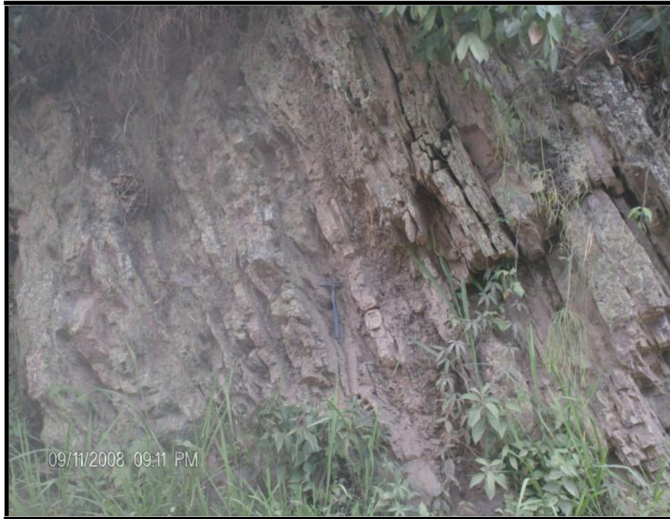
Figura 26. Formación Aguardiente. Vía Arboledas – Cucutilla. Segmento 6 (350 m). Capas delgadas a medias de areniscas cuarzosas de grano grueso, lodosas, tabulares, con contactos netos a ligeramente ondulados.
