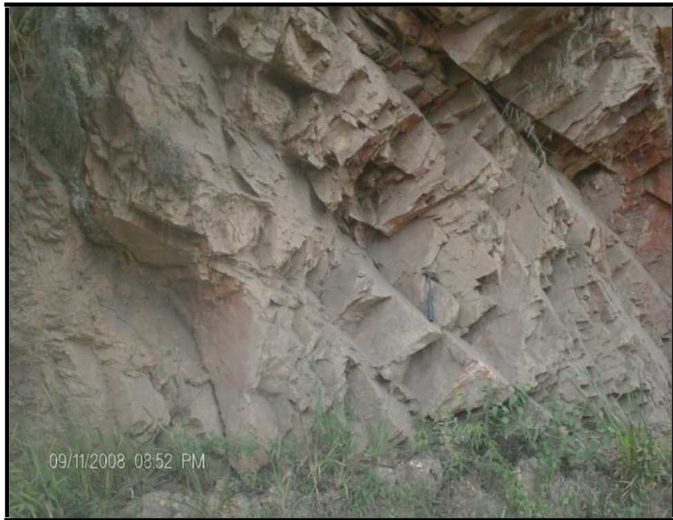
Figura 25. Formación Aguardiente. Vía Arboledas –Cucutilla. Segmento 4 (323.93 m). Capas muy gruesas de areniscas cuarzosas de grano muy fino, tabulares, limpias, intercaladas con capas finas de limolitas silíceas.
