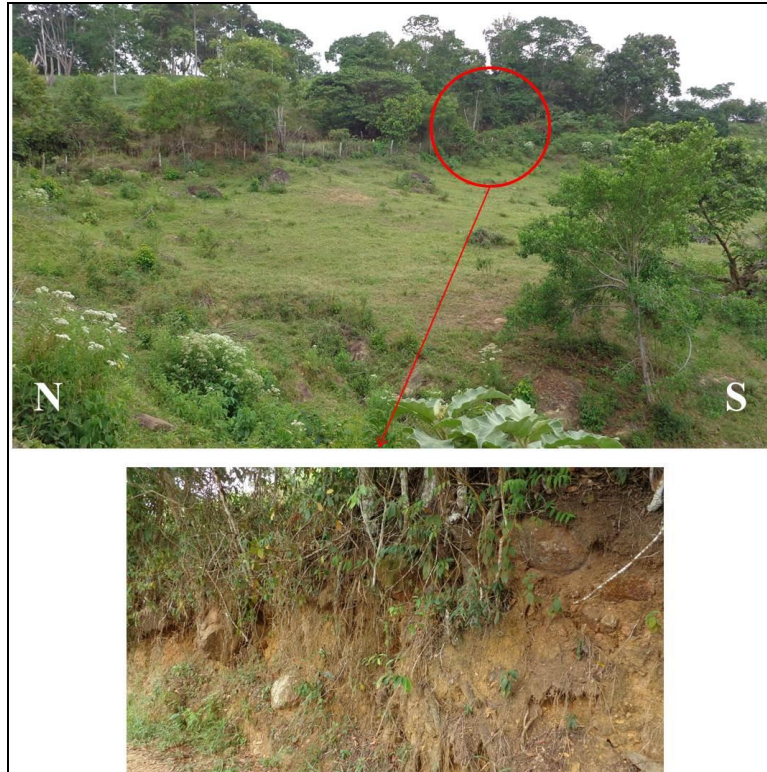
Figura 46. Panorámica E de la vía Galápagos-Centro Menzulí, en donde se observa un depósito coluvial antiguo sobre el Escarpe de meseta encontrado en el sector de Galápagos.
