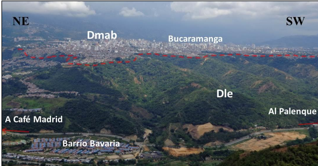
Figura 23. Panorámica SE de la unidad Mesa de Abanico Dmab. Fotografía tomada desde el Municipio de Lebrija en inmediaciones entre las veredas Puyana y El Progreso. Se observa la parte distal del abanico de Bucaramanga muy disectado, con evidencias de erosión en cárcavas. La línea roja indica límite entre geoformas.
