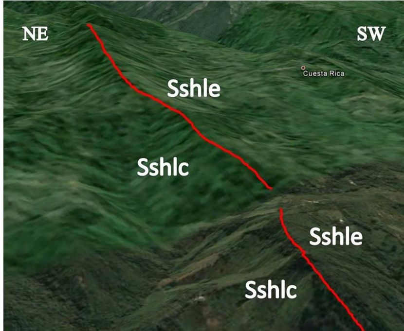
Figura 50. Panorámica SE de la unidad de Ladera estructural de Sierra Homoclinal “Sshle”. Imagen satelital en vista 3D extraída de Google Earth. Se detalla la morfología recta y elongada de esta unidad, que a diferencia de Sshlc, tiene pendiente inclinada y la longitud es moderadamente larga. La línea roja indica límite entre geoformas.
