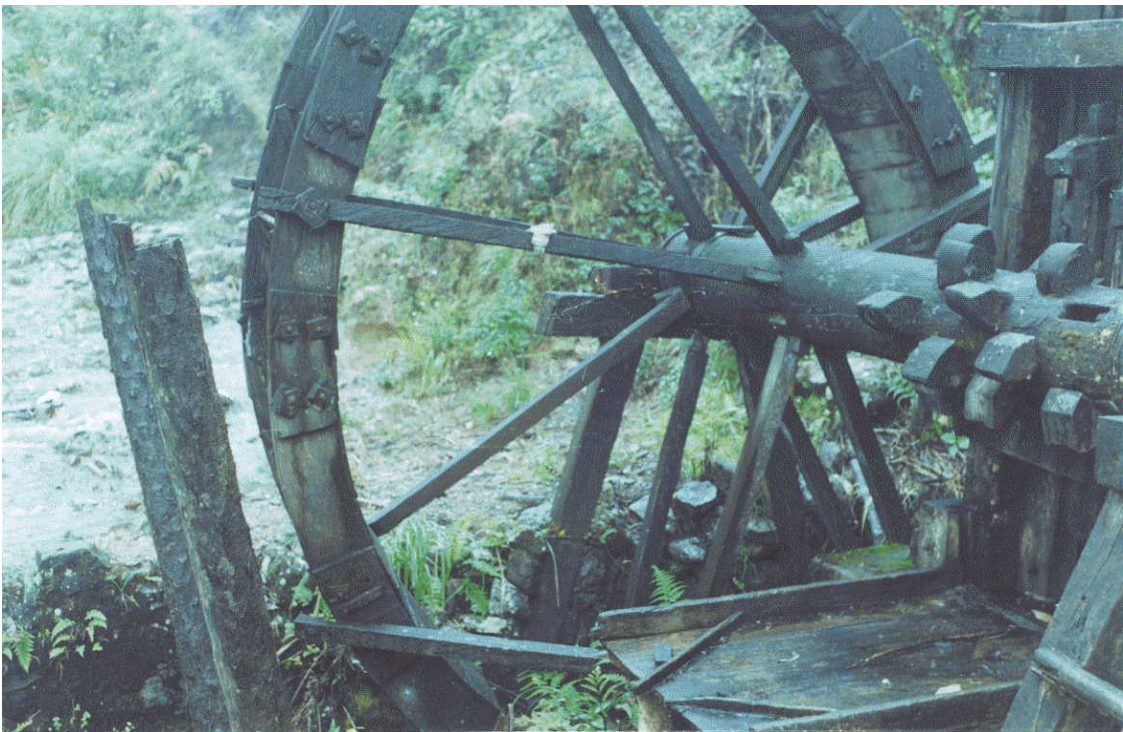
Figura 48. Molinos de pisones en la mina Bombona.
