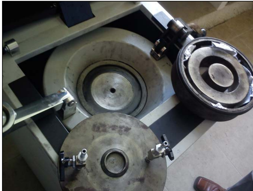
Figura 29. Molino empleado para la determinación de gas residual en una muestra de carbón
