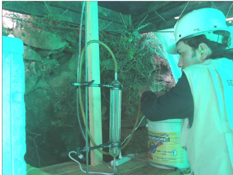
Figura 28. Sistema de medición del gas perdido en muestras de carbón pozo Socotá-1.
