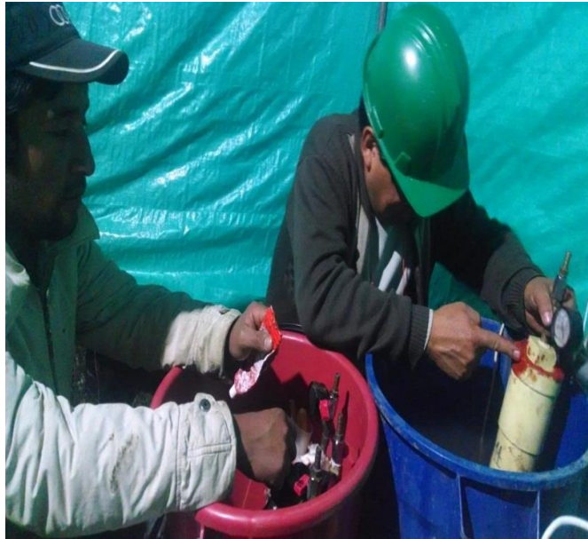
Figura 83. Pruebas de hermeticidad en los canister. Muestreo frente de mina.
