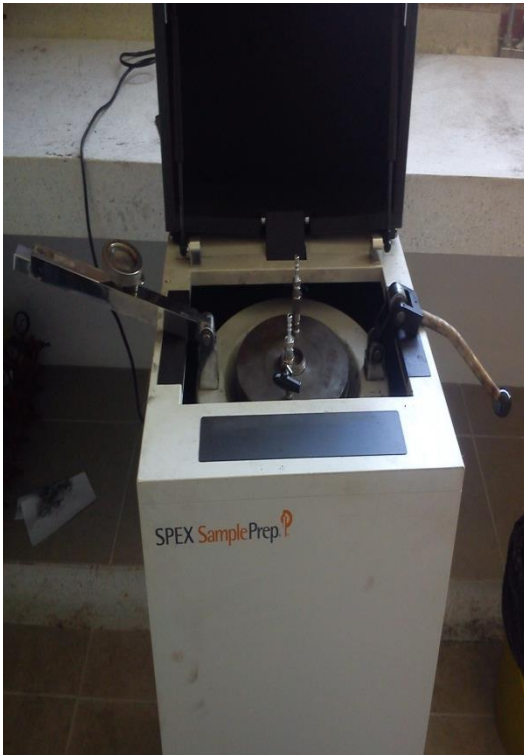
Figuras 87 y 88. Molino empleado para la determinación de gas residual en una muestra de carbón.
