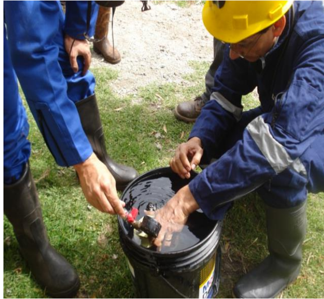
Figura 82. Pruebas de hermeticidad en los canister. Muestreo frente de mina.
