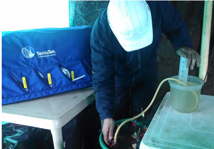
Figura 84. Sistema de medición del gas perdido en muestras de carbón pozo Úmbita -1.
