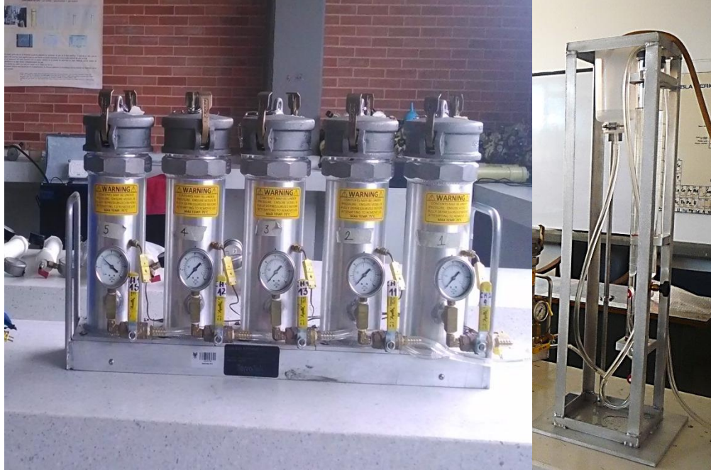
Figura 86. Medición de contenidos de gas metano en muestras de pozo. Sistema de medición con control de temperatura (izquierda) y sistema de medición con buretas (derecha).
