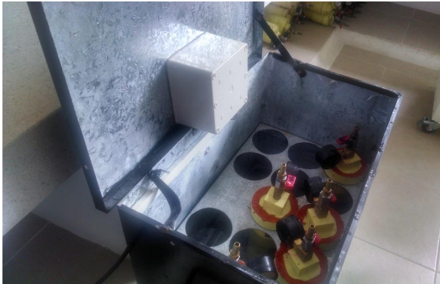
Figura 85. Conservación de la temperatura de los canister en un baño termostático.
