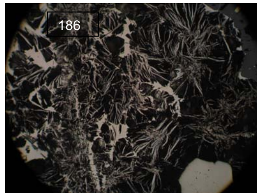
Foto 181. Galena intercrecida con esfalerita y rellenando una pequeña venilla (320X). Foto 182. Inclusión de bornita en pirita (320X). Foto 183. Inclusión de arsenopirita en pirita (320X). Foto 184 y 185. Microinclusiones de oro en pirita (500X). Foto 186. Marcasita con textura característica (320X)
