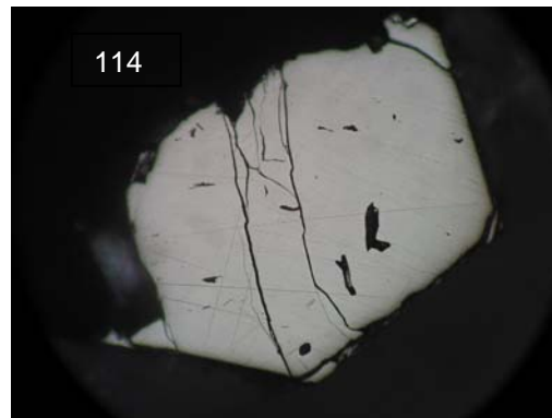
Foto 113. Cristal de pirita euedral, con algunas inclusiones de los minerales de la ganga (200X). Foto 114. Cristal de pirita subedral levemente fracturado (320X).
