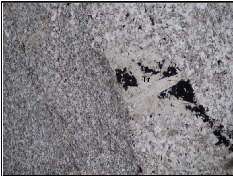
**IGM- 706514.** Cornubianita de actinolita, plagioclasa, cuarzo (milonítica). Escala 3.1 x 23.5 mm. Nícoles paralelos. Bandas microcristalina con tamaño de grano diferente. Se observan nidos de tremolita (Tr) junto a opacos.
