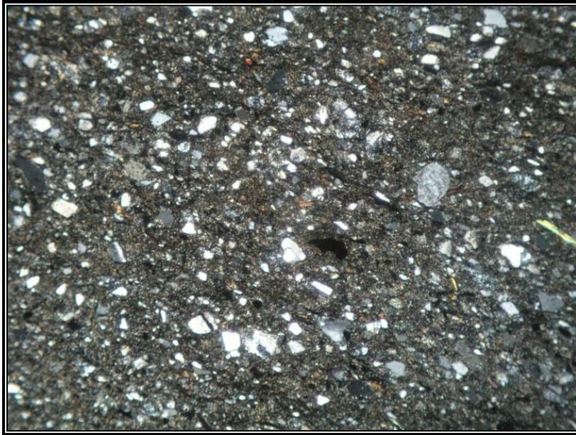
**IGM-706817.** Metalodolita (milonita). Escala 3.1 x 2.5 mm. Nícoles cruzados. Granos de cuarzo de tamaño limo flotando en una matriz arcillosa.
