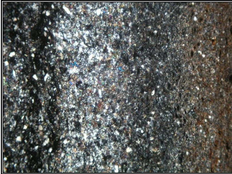
**IGM- 706804:** Cornubianita de epidota - actinolita – cuarzo – biotita. Escala 3.1 x 2.5 mm. Nícoles cruzados. Bandas con agregados microcristalinos de epidota y biotita.
