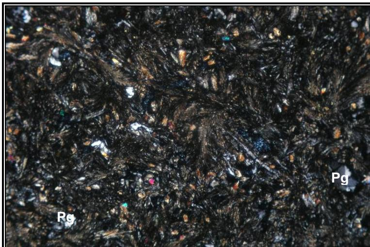
**IGM-706558.** Basalto Escala: 3.1 x 2.5 mm. Nícoles cruzados. Microfenocristales dispersos y aislados de plagioclasa (Pg) en matriz variolítica formada por agregados radiales, en abanico de plagioclasa con clinopiroxeno intergranular y vidrio volcánico.
