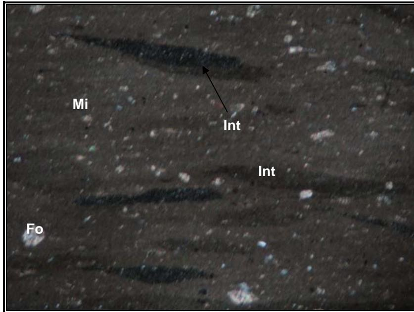
**IGM-706521.** Micrita fosilífera con intraclastos. Escala 3.1 x 2.5 mm. Nícoles cruzados. Intraclastos (Int), restos fósiles (Fo) y ooides flotando en lodo micrítico (Mi).
