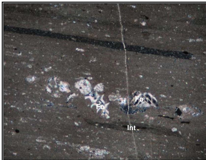
**IGM-706521.** Micrita fosilífera con intraclastos. Escala 3.1 x 2.5 mm. Nícoles cruzados. Intraclastos (Int) y restos fósiles (Fo) reemplazados por calcita.
