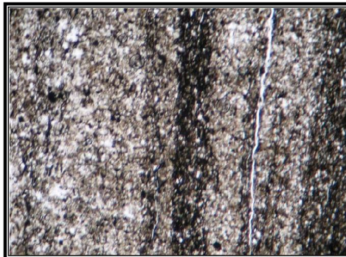
**IGM. 706529.** Lodolita laminada. Área de la microfotografía: 3.1 x 2.5 mm. Nicoles paralelos. Roca clástica con laminación fina plano-paralela continua marcada por cambios en la coloración debidos a la acumulación de materia orgánica. Fragmentos de cuarzo bien seleccionados flotantes en matriz limo-arcillosa.
