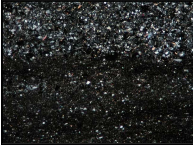
**IGM-706532.** Láminas de Lodolita y limolita. Escala 3.1 x 2.5. Nícoles cruzados. Láminas de limolita y lodolita con granos de tamaño limo de cuarzo, moscovita.
