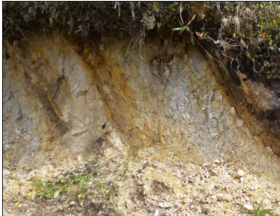
Figura 17. Capas muy gruesas de arcillolitas color gris claro, amarillo por meteorización, en la parte alta de la Formación Guaduas. Fotografía tomada en el punto con coordenadas N: 1003795, E: 1008603.
