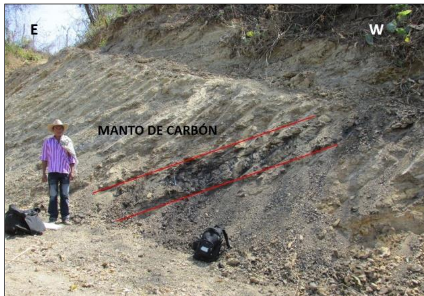
Fotografía 65. Manto de carbón intercalado en areniscas de grano muy fino de la Formación San Fernando, en la vereda Santa Helena, Estación HLM-0022, 1 133 948 m.N y 875 670 m.E.
